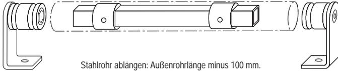
Stahlrohr ablängen: Außenrohrlänge minus 100 mm.
