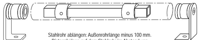
Stahlrohr ablängen: Außenrohrlänge minus 100 mm. Distanzhülsen auf dem Stahlrohr im Abstand von 350 mm verteilen und fixieren. Anschließend montieren.
