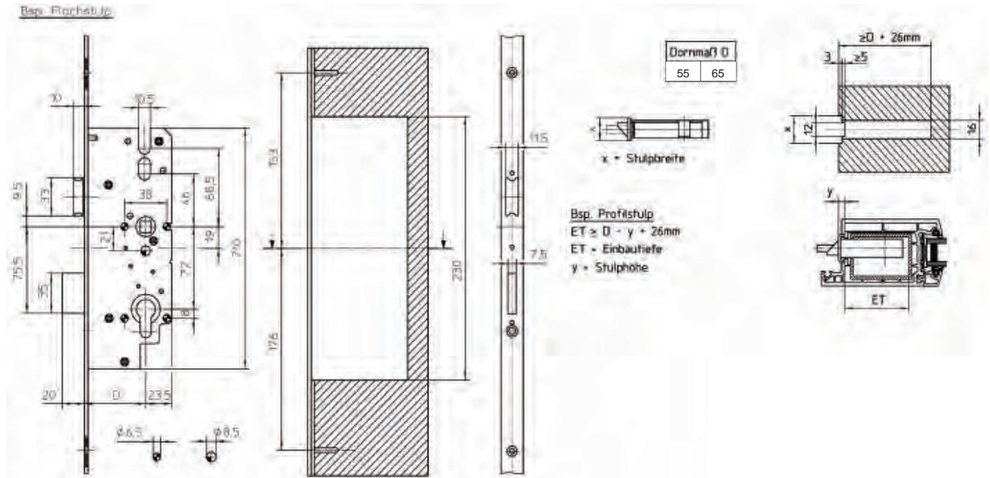
HAUPTSCHLOSS EE 960, PE 960 ENTFERNUNG 72 UND 92 MM
