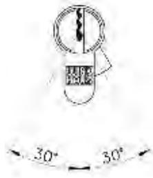
Profilzylinder mit **Anti-Blockade-Funktion** notwendig. Schließbart 360° freilaufend.
