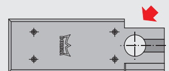
Ausklingung bei DIN-R-Türen
