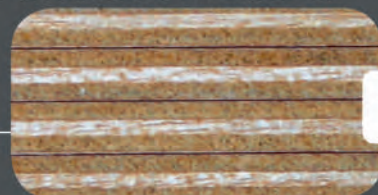
Querschnitt Sperrholz-Trägerplatte Fugendicht
