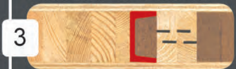
Querschnitt mit Mittellage Massivholz u. parafingebundene HoFa
